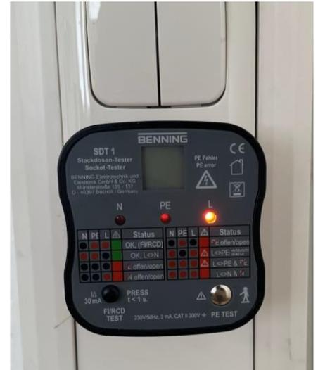
*Teststecker – Spannung prüfen*
