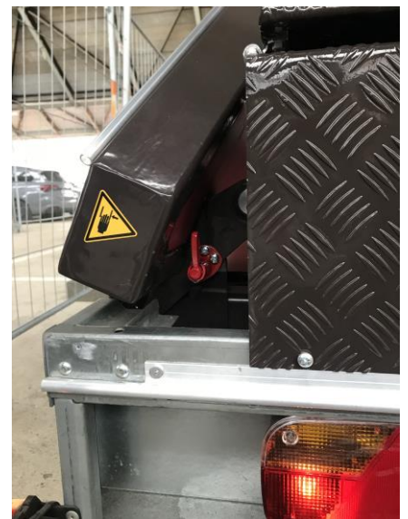
Roten Winkelbolzen rechts & links lösen, nach oben zeigend, wie hier = FEST, nach unten zeigend = GELÖST
